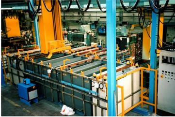
Un poste de dégraissage est utilisé pour décaper des pièces avant un traitement de surface. Ce poste se compose d'une zone de chargement, d'une zone de déchargement, d'une cuve de dégraissage et d'un chariot automoteur se déplaçant sur un rail. Ce chariot permet de déplacer un panier contenant les pièces à traiter.
